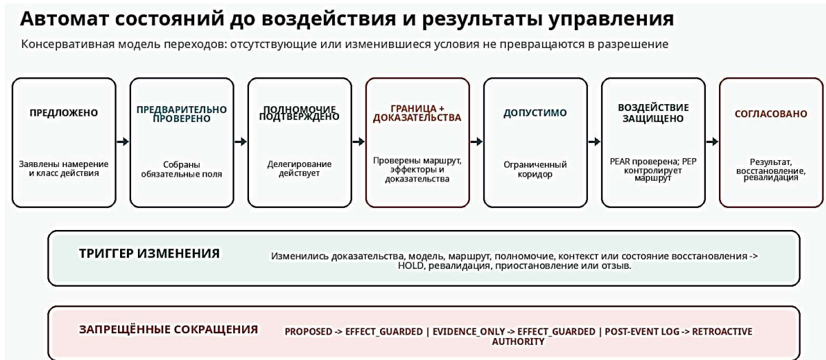
Рисунок 2. Консервативный автомат состояний до воздействия, триггеры изменений и запрещённые сокращённые пути. Источник: автор.
